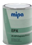
Mipa 2K-EP-Expressprimer EPX Fondo riempitivo bagnato su bagnato a base di resine epossidiche. Buona distensione ed ottima brillantezza. Rapida essiccazione, sovraverniciabilità e carteggiabilità, Grigio chiaro. Rapporto di miscela: 1:1 Catalizzatore: Mipa 2K-EP-Expresshärter EPH
